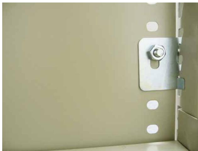
背パネルを上下の金具に位置を合わせボルトナットで仮締めします。
