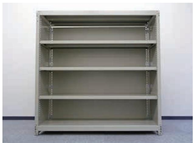
仮止めが全て終わりましたらボルトナットを本締めし、側パネル(片側)の取付け完成です
