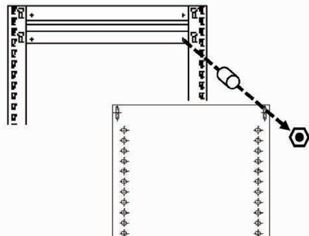
天地受（最上段・最下段の棚受）の下部穴にパネルを仮止めします。
